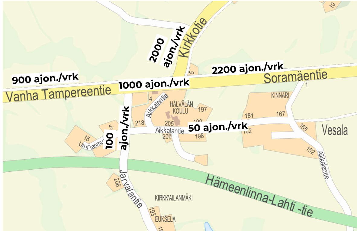
Kuva 4. Asiantuntija-arvio suunnittelualueen nykyliikennemääristä (KVL, ajon./vrk) perustuen Väyläviraston liikennemäärätietoihin ja Päijät-Hämeen liikennemallin nykytilaennusteeseen.
